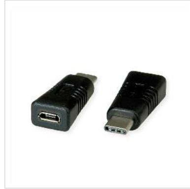
**USB-Adapter mit einer MicroB-Buchse und einem Typ-C-Stecker. Unterstützt USB On-the-go (OTG).**
