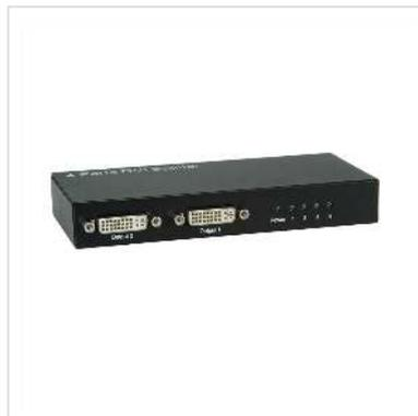
**Der Video-Verteiler stellt den Video-Output von einer Video-Quelle auf vier Monitoren oder Projektoren dar.**
